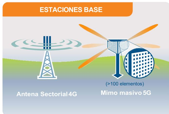
Estación base sectorial 4G y estación base 5G con una nueva antena MIMO masiva multielemento orientable. Se espera que el tamaño físico total de la estación base de la antena 5G sea similar al de la estación base de la antena 4G.
